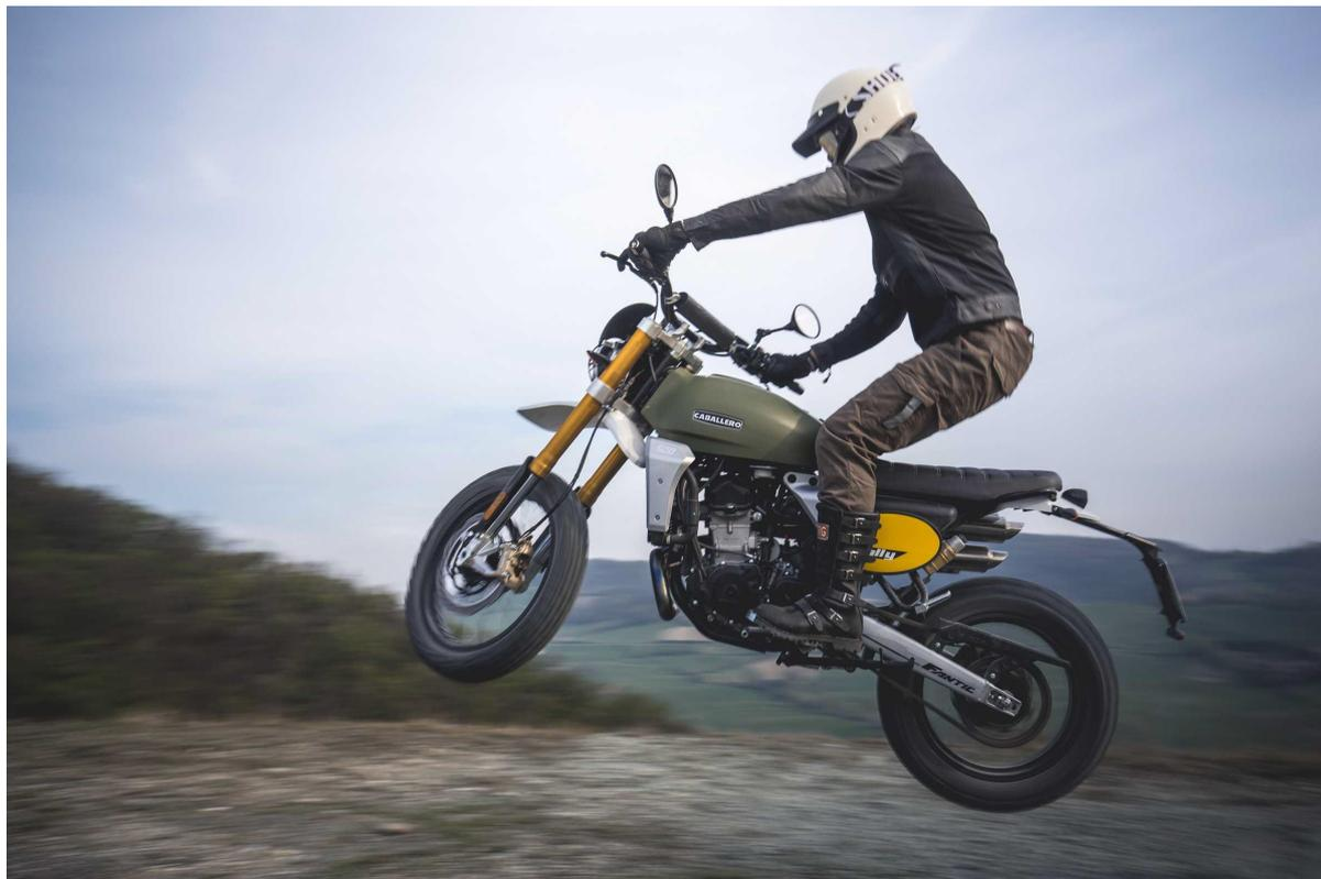
11月下旬、CABALLEROシリーズの最新モデル「RALLY500」が遂に日本で販売開始となります。排気量は500ccのみの設定。スイングアームはアルミ製、前後のサスペンションストロークは200mmへと拡大、減衰調整機構も備え、大幅にグレードアップ。アルミ製エンジンガードやヘッドライトプロテクター、ラジエターガードなどが標準装備となり、すぐにでもオフロードを楽しむことができる車両となっています。
