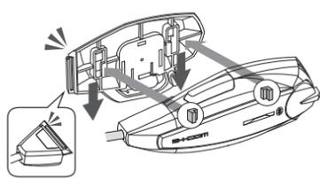
※アームマイク使用時はマイクの突起とベースの溝を合わせてスライドさせてください。取付が不十分な場合、脱落する恐れがございます。
