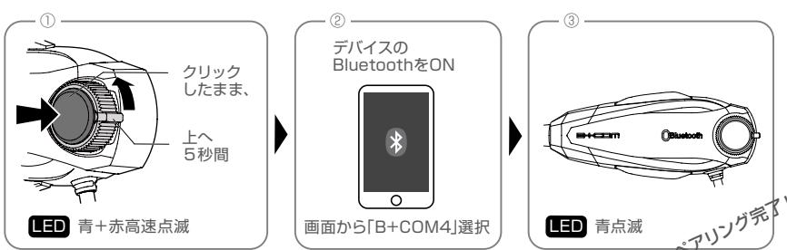
⚠ ペアリング操作中は、B+COMおよびペアリングを行うデバイス以外のBluetooth機能をOFFにしてください。
