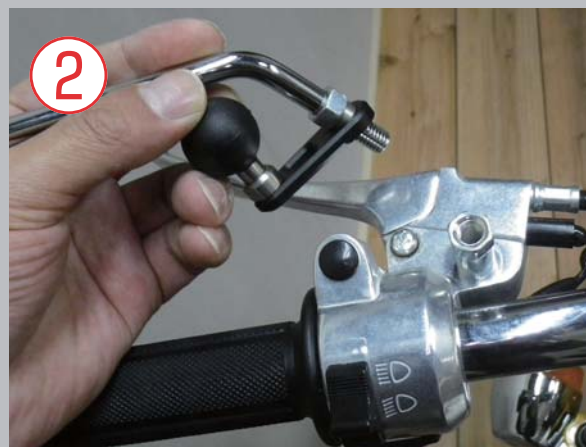
ミラーを取り外し本体を仮組します。
