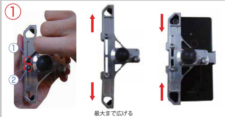
①②のボルトを六角レンチで緩め上下のガイドを最大まで開いた状態でデバイスを差し込み矢印方向にガイドをデバイスのサイズにあわせませす。
