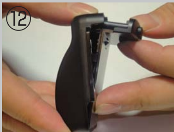
⑫ ボタンとボタン穴の位置を合わせながらナビ接地面カバーを取り付けます。
