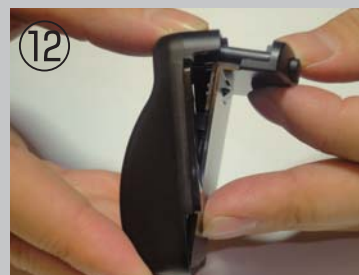
ボタンとボタン穴の位置を合わせながらナビ接地面カバーを取り付けます。
