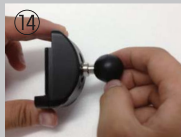
⑭ マウントパーツを取り付けます。※スパナを使用して、しっかりと締めてください。要ネジロック剤塗布
