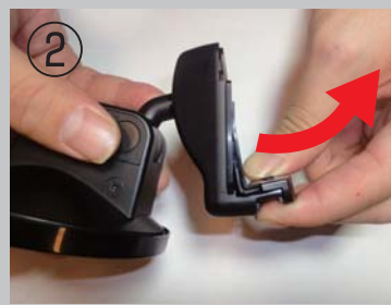
② ナビ接地面カバーを外します。
