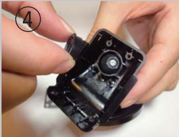
④ ボールカバーを外し、ボールのビスを外します。
