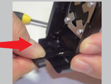
⑪ ボタンにスプリングをはめ込み、ボタンをマウントに取り付けます。
