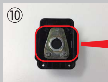
③で外したプレートをビスで固定します。※プレートの向きに注意してください。凸面が表になります。
