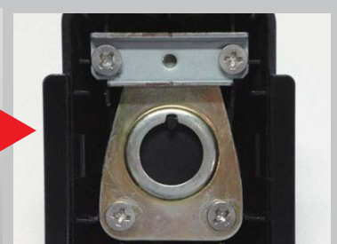
③で外したプレートをビスで固定します。※プレートの向きに注意してください。凸面が表になります。
