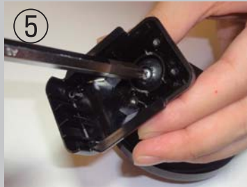
④ ボールカバーを外し、ボールのビスを外します。
