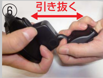
部品をしっかり押さえ、お互いを引っ張り部品を引き抜きます。
