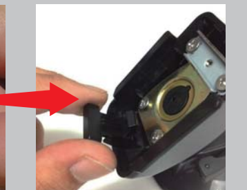
⑪ ボタンにスプリングをはめ込み、ボタンをマウントに取り付けます。
