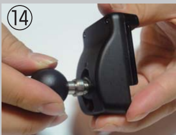
⑭ 写真⑩の様に、マウントパーツを取り付けます。※スパナを使用してしっかりと締めてください。要ネジロック剤塗布
