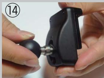
⑭ 写真⑩の様に、マウントパーツを取り付けます。※スパナを使用してしっかりと締めて下さい。要ネジロック剤塗布
