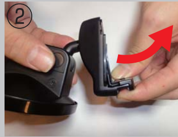
② ナビ接地面カバーを外します。
