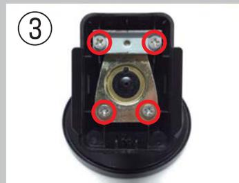
③ ○のビス(4か所)を外し、プレートを外します。※ビスがなめないように注意してください。
