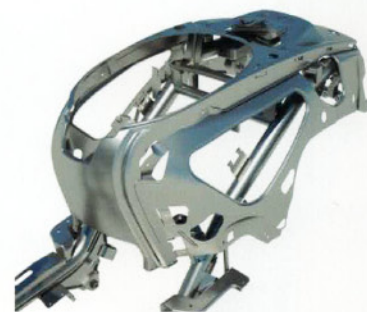
車体中心にスチールパイプを置き、そこにプレス鋼板パネルをレイアウトする車体設計は、かつてのモデル同様だ。現代のスクーターの礎を築いたブランドは、「鉄スクーター」として現代に蘇ったのだ。
