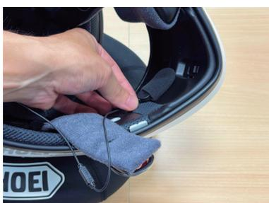
集音部(穴の空いている面)が口元を向くようにして、ワイヤーマイクをスポンジへ差し込みます。
