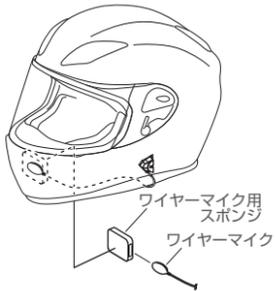
チンガード部の口元に接着シート付きのワイヤーマイク用スポンジを貼り付けます。なるべく下からの巻き込み風が少ない位置に設置してください。
