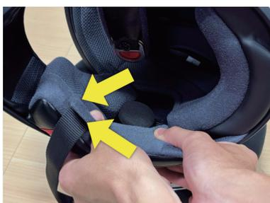
スピーカーを取付けます。イヤースペースにそのまま合わせるのではなく、**できる限りヘルメット前方、チンストラップの根元側へ寄せるのがコツ**です。
