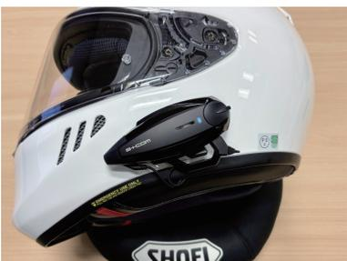
本体ユニットを取付け、ワイヤーマイクやスピーカーのコネクタを接続します。スピーカーコネクタは、本体後ろ側に配線が出る向きで接続します。
