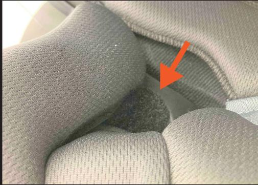
左右のスピーカー貼り付け位置へ、スピーカー固定用面ファスナー(メス)を貼り付けます。
