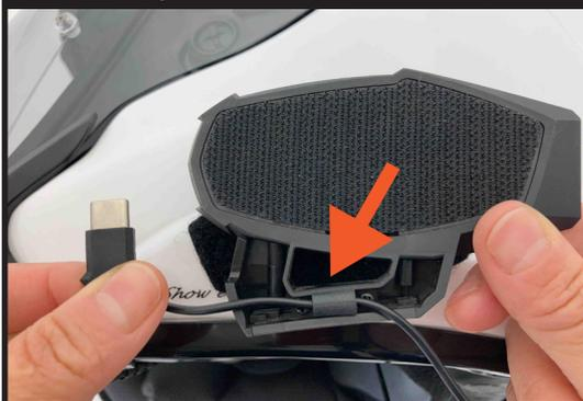
ベースプレートを貼り付ける前に、「スピーカー固定用ハーネスクリップ」を使用して、スピーカーの配線を留めておくとスムーズです。
