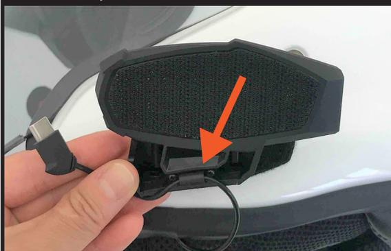
ベースプレートを貼り付ける前に、「スピーカー固定用ハーネスクリップ」を使用して、スピーカーの配線を留めておくとスムーズです。
