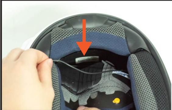
ヘルメット内装のスナップを外し、配線をスナップの内側に通していきます。
