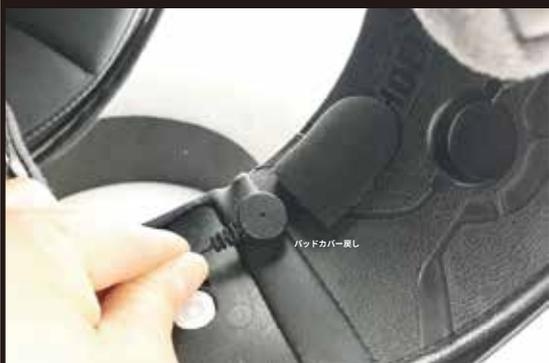
集音部 ( 穴の空いている面 ) が口元を向くようにして、ワイヤーマイクをスポンジへ差し込みます。
