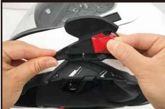
アタッチメントの剥離シートを剥がし、ヘルメットの形状に合わせて貼付けます。
