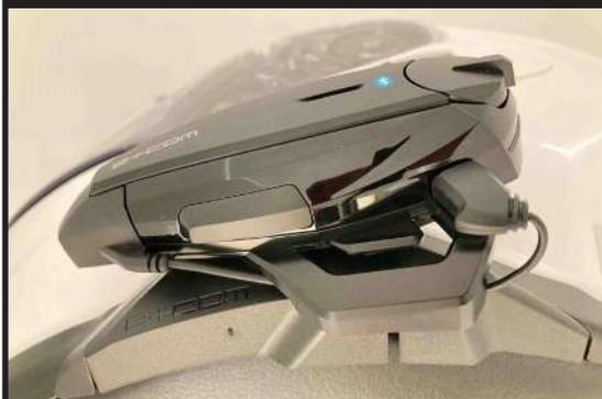
B+COM 本体ユニットをベースに取り付け、マイクとスピーカーを接続します。
