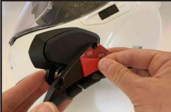
アタッチメントの剥離シートを剥がし、ヘルメットの形状に合わせて貼り付けます。
