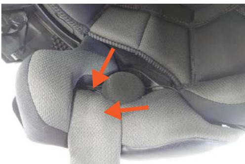
「スピーカー」を取り付けます。イヤールールにそのまま合わせるのではなく、できる限りヘルメット前方、チンストラップの根本側へ寄せるのがコツです。
