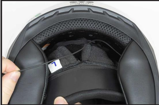
ヘルメット内装のスナップを外し、配線をスナップの内側に通します。
