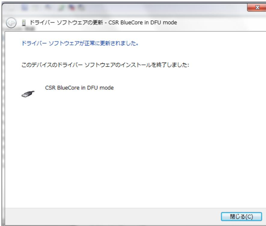
更新が完了したら、B+COM を PC から取り外し接続し直して、②を確認して下さい。
