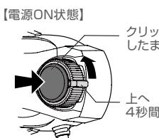
電源ON状態で、デバイスボタンをクリックしたまま、ボリュームダイヤルを上へ4秒以上固定します。
