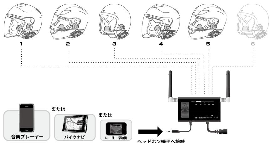
**⚠️** B+COM Stationと接続する場合の通信距離はStationを中心に、半径約100m前後となります。また、通話音質はSB4X同士よりも多少低下します。
