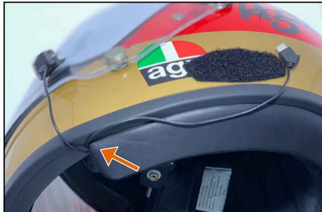
マイクとスピーカーの配線は、図の内装の隙間から通し、
