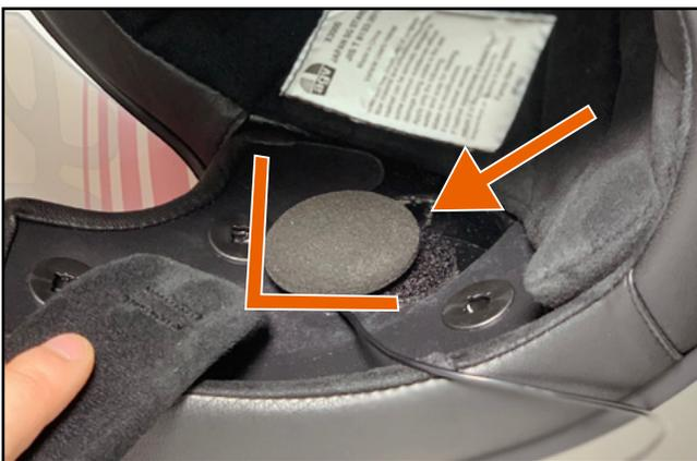
スピーカー位置の微調整をします。耳とスピーカーの間に隙間がある場合、必ずスピーカー調整スポンジで調整してください。
