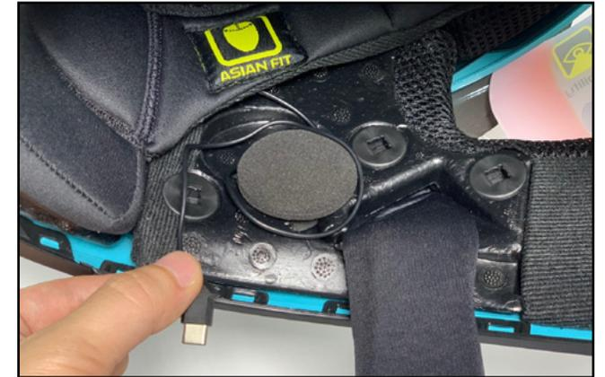
配線が余る場合には、スナップやスピーカーの周囲に巻き付けるようにして長さを調節してください。
