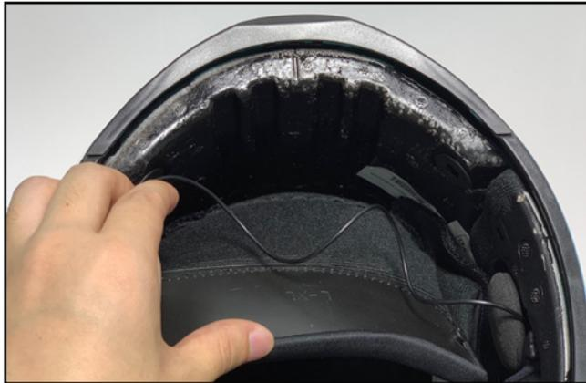
ヘルメット後方のスナップ2つを外し、配線をスナップの内側に通します。
