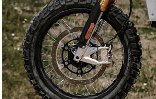
320mmのフローティングディスクローターにラジアルマウントのキャリパー。高性能な装備が足元を固めます
