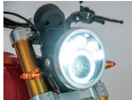
ヘッドライトにはLEDを採用。 LOWでは中心部が、HIでは上部5つのLEDが点灯する。
