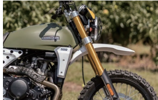
フロントストロークの確保と悪路での泥の巻き上げに効果的なハイマウント・フロントフェンダー。
