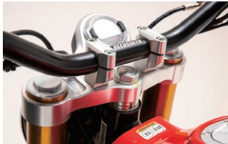
トップブリッジ、ハンドルランプには、高剛性な ビレットパーツを用いる。
