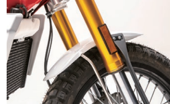
φ41mmの倒立フロントフォーク。フィンダーサポート にもスクランブラーらしい造形へのこだわりを表現。
