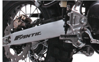
アルミスイングアーム、リヤブレーキキャリパーもフロント同様バイレ製。ディスク径はφ230mm。
