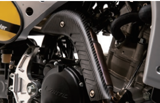
ヒートプロテクターには、折り目が美しい 縫織りのドライカーボンを使用。
