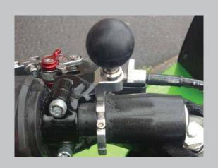
ナローマウントの取り付け位置は、必ず 左右どちらかに寄せて取り付けて下さい。 隙間がありますと、振動によるブレや位置 調整した際の過度な力により破損する恐れ がございます。
