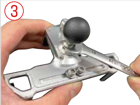
10mm のレンチ工具でしっかりと固定します。
