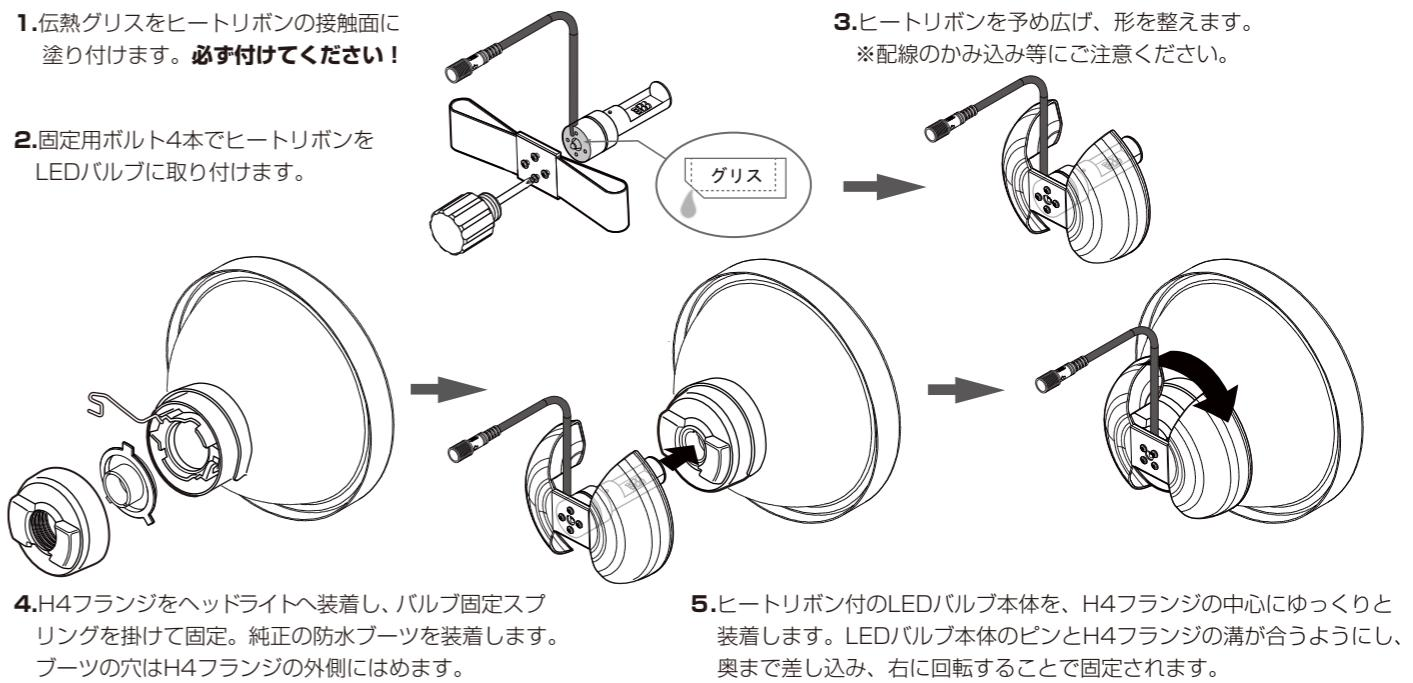
図のヒートリボンは横向きですが、車種により縦向きでの取付の方が収まりが良い場合がありますので、任意の向きで取付を行ってください。
