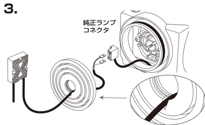
コントローラーの電源ケーブルを防水ブーツの穴から通し、ライトケース内のランプコネクタに接続します。
