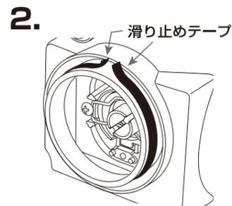
防水キャップを固定する側面へ、滑り止めテープを貼り付けます。
