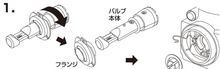
バルブ本体からフランジを取り外し、ヘッドライトへ装着します。
