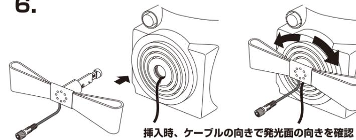
バルブ本体を、フランジに装着します。LEDバルブ本体のピンをフランジの溝に合わせながらゆっくり奥まで差し込み、右または左に回転すると固定されます。(3段階の角度で調整できます。)
