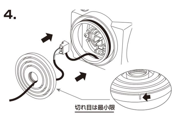
キャップの口径に合う溝に沿って、付属の防水ブーツを嵌め込みます。
