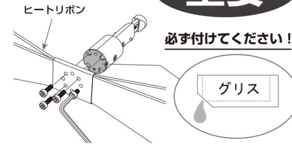
接合面に伝熱グリスをたっぷり塗り付け、ヒートリボンを付属の固定用ボルト4本で確実に締付けてください。ヒートリボンと伝熱グリスは、明るさを維持するための重要部品です。必ず使用してください。
