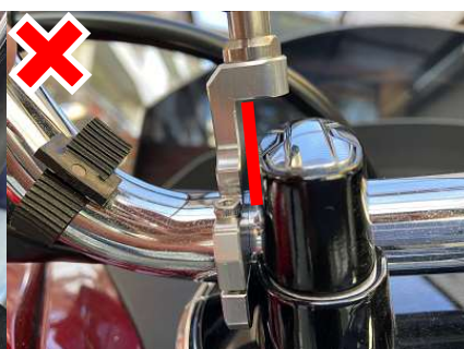
✕ 取付部隙間あり (C-27)
